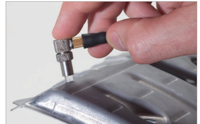
Измерение утонения металла после формования.
