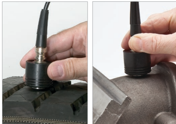
Измерение глубины залегания стального/плетеного корда в резиновых конвейерных лентах и автомобильных покрышках.
