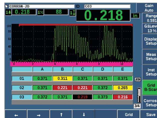
EPOCH 650 — Модуль для коррозионного мониторинга
